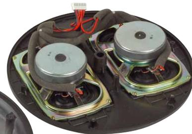
Das Gehäuse ist komplett aus Alu-Druckguss gefertigt, die Elektronik braucht nur einen Verstärkerchip für alles
