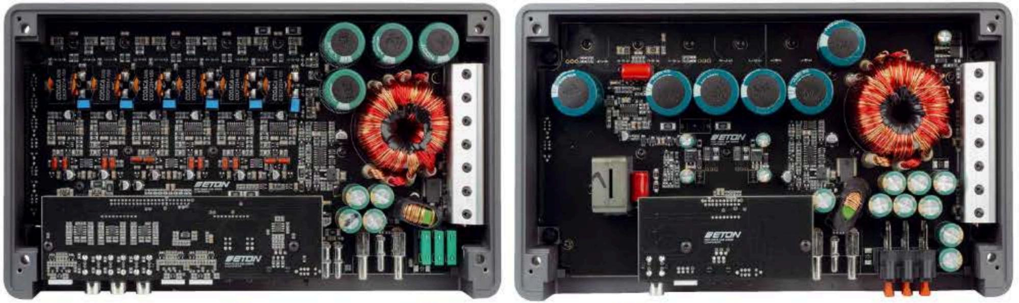
Groß dimensionierte Netzteile, jede Menge Pufferelkos, gekapselte Filterspulen – der Aufbau der MA Verstärker verspricht schon optisch viel Leistung
