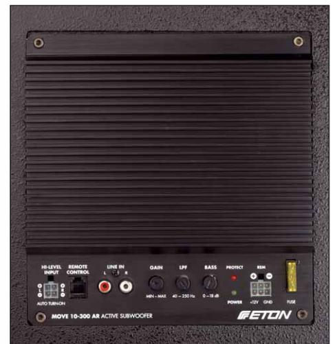
Einfacher Anschluss: Eingänge und Stromversorgung lassen sich dank Molex-Steckverbindern schnell verbinden und trennen
