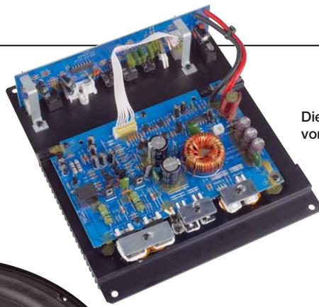
Die Leistung kommt bei beiden Woofern von einer analogen Mono-Endstufe
