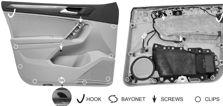
Öffnen Sie zunächst den Bayonettschluss an der Unterseite mit einem SW 10 Maulschlüssel, verdrehen Sie den verschluss auf 90°, so dass dieser vertikal steht. Danach heben Sie die Klippe von unten beginnend vorsichtig ab. Dann die Türverkleidung vorsichtig nach oben aus dem Fensterschacht heben. Achten Sie dabei auf den Schnapphaken im äußeren Bereich, dieser muss nach oben hin ausgehangen werden.
