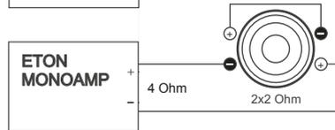
Bei Auswahl des passenden Verstärkers (AMPs) oder Subwoofer darf die Verstärker-Ausgangs impedanz (Ohm) nicht unterschritten werden!
