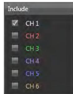
Klicken Sie die entsprechende Checkbox des Kanals an, den Sie über den Remote Regler beeinflussen wollen. Bei aktiviertem Kanal erscheint Ihnen ein Hakensymbol in der Check-box.
