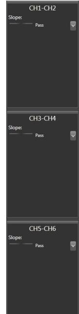
In diesem Fenster haben Sie die Möglichkeit den gewünschten Filter zu bestimmen. Klicken Sie dazu den Drop-down Pfeil. Wählen Sie in dem sich nun öffnenden Fenster das gewünschte Filter aus das Sie für diese Kanalgruppe benötigen. Sie haben die Wahl zwischen Hochpass; Tiefpass und Bandpass.
