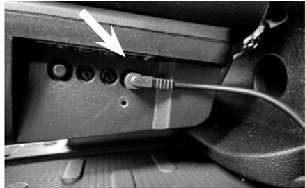
Stecken Sie nun die Kabelfernbedienung im Anschluss "REM" ein. Achten Sie beim Anbringen der Abdeckung darauf, dass das Kabel durch die Aussparung im Deckel sich befindet.
