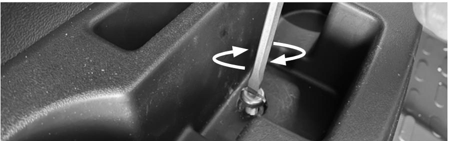
Legen Sie anschließend die Gummiabdeckmatte über die Schraube und Clipsen Sie bei Ducato III Serie 7 die Abdeckstopfen ein.
