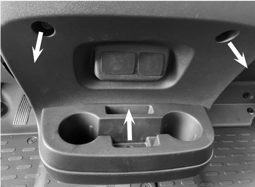
**Schritt 2):** Entfernen Sie die Gummi-Abdeckmatte in der Mitte der Konsole, darunter befindet sich ebenfalls eine Schraube, entfernen Sie diese.
