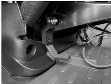
**Schritt 14):** Setzen Sie danach den Getränkehalter ein. Achten Sie darauf, dass alle Klipse ordnungsgemäß einrasten, abgebrochene Klipse/Metallklammern sollten ersetzt werden. Stellen Sie sicher, dass beim Einsetzen des Getränkehalters, keine Anschlusskabel gequetscht oder beschädigt werden.
