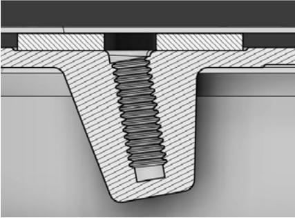
**ACHTUNG!** Das Gewinde für die zentrale Befestigungsschraube ist schräg im Aluminium-Druckgussgehäuse integriert, wird die Schraube im 90° Winkel angesetzt, wird das Gewinde beschädigt!
