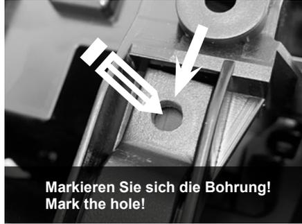
Entfernen Sie danach die Schrauben wieder und ziehen Sie den Grundträger aus dem Getränkehalter heraus und bohren Sie mit einem 8 mm Bohrer die beiden angezeichneten Löcher. Sie können auch hier den Halter als Bohrschablone verwenden.
