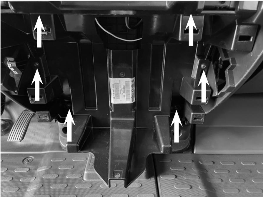
Sind alle Schrauben entfernt, können Sie den Halter des Getränkehalters leicht entnehmen. Ziehen Sie übrig gebliebene Metallklammern vorsichtig vom Grundträger ab und stecken Sie diese wieder ordnungsgemäß auf den Getränkehalter auf. Abgebrochene oder verbogene Halter/Clipse tauschen Sie durch neue aus.
